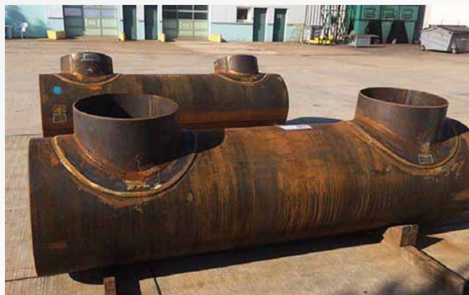
En større sag bliver netop leveret til HOFOR A/S, hvor det nye AMV4 kraftværk stal stå klart. Her er et udpluk, et specialfremstillet dobbelt t-stykke.
