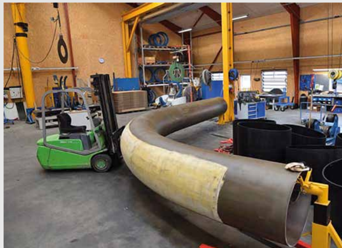
Induktionsbukket bøjning DN800, 813 x 12 i radius 4064, 80 grader til udskiftning på hovedforsyningslinien ved Avedøreværket.
